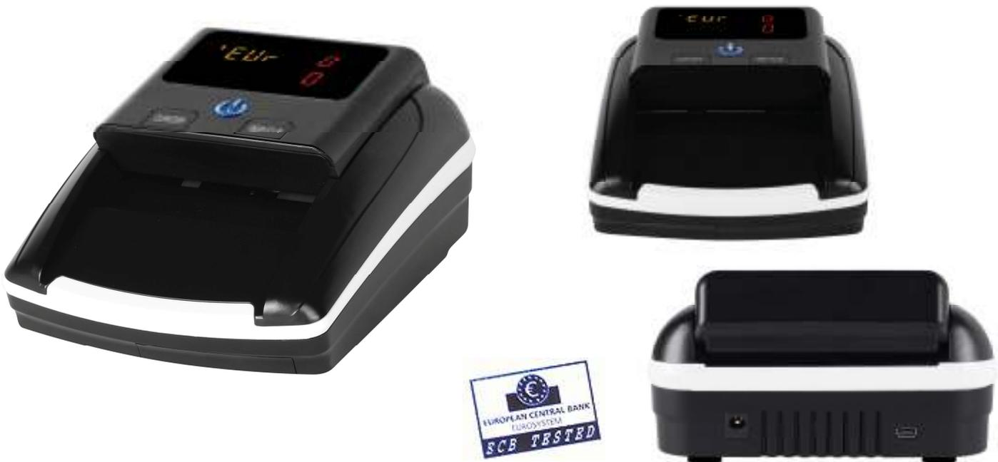
FAST CONTROL è un verificatore di tutte le banconote Euro che esegue tramite lettura magnetica e comparazione dei dati il controllo della presenza del filo di sicurezza, dell'inchiostro magnetico, della dimensione, del colore, dell'infrarosso e dell'ultravioletto.
